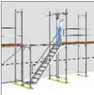
Rys. 53: Połączenie z rusztowaniem głównym
