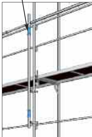
Rys. 12 i 13: Podłączenie słupka montażowego do ramy pionowej Blitz
