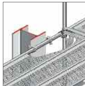
Rys. 46: Zakotwienie do podpory pionowej
