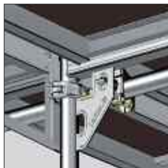
Rys. 43: Szczegół połączenia złącza z blachą węzłową
