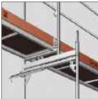
Rys. 95: Zastosowanie elementu redukującego
