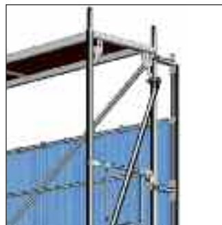
Rys. 118: Przykład zabudowy systemu plandek kederowych z wzmocnieniem
