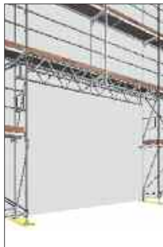
Rys. 85: Przewieszenie z użyciem dźwigara kratowego
