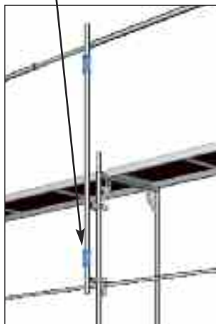
Rys. 12 i 13: Podłączenie słupka montażowego do ramy pionowej Blitz
