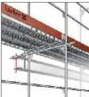
Rys. 48: Zakotwienie do belki poziomej
