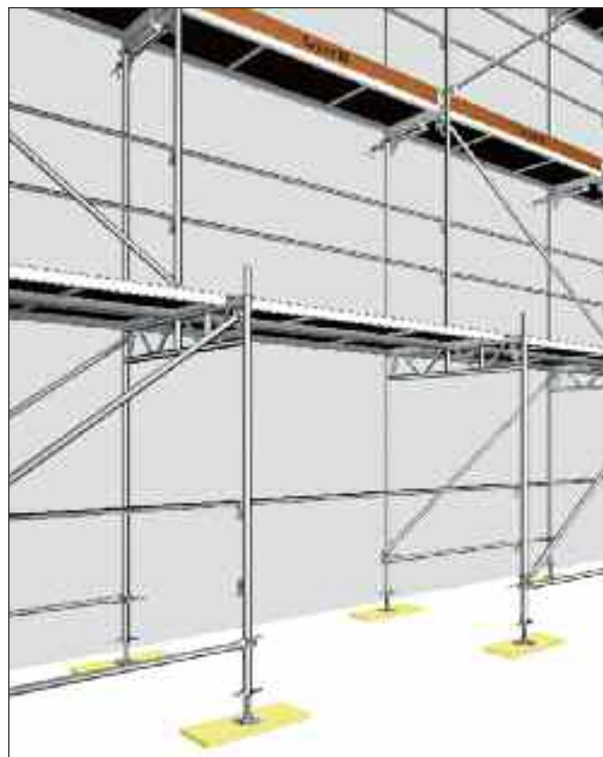
Rys. 93: Montaż ramy przejściowej
