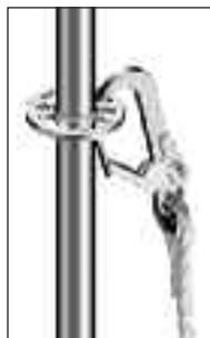
Rys. 28: Zaczepienie jest możliwe do dużego i małego otworu tarczy rozetowej
