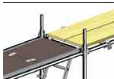
Rys. 51: Grube deski montażowe na ryglach nakładanych
