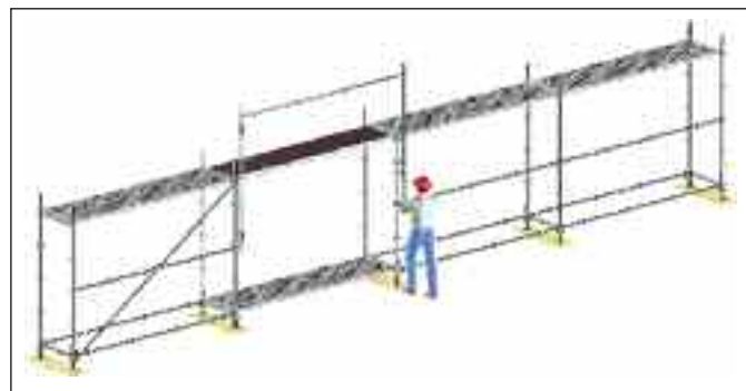
Rys. 35: Zastosowanie ochronnej poręczy wyprzedzającej w polu z przejściem
